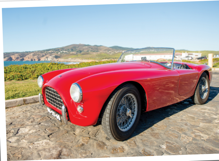
À LUPA: Origem: britânica; Ano: 1956; Marca: AC Cars; Modelo: AC Ace; Estilo: roadster de duas portas; Motor: 2.0L, de seis cilindros em linha; Velocidades: quatro e marcha-atrás; Consumo médio: 12 litros aos 100 km; Capota: em lona e amovível; Carroçaria: em alumínio; Chassi: em ferro.
